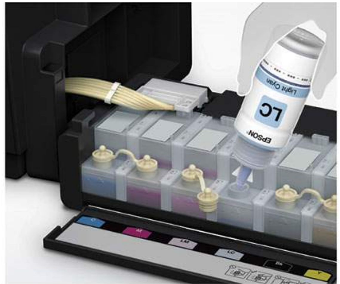
ท่อหมึกที่ยืดหยุ่นเป็นพิเศษ ทำให้มั่นใจได้ว่า จะไม่มีการรั่วไหลของหมึก
