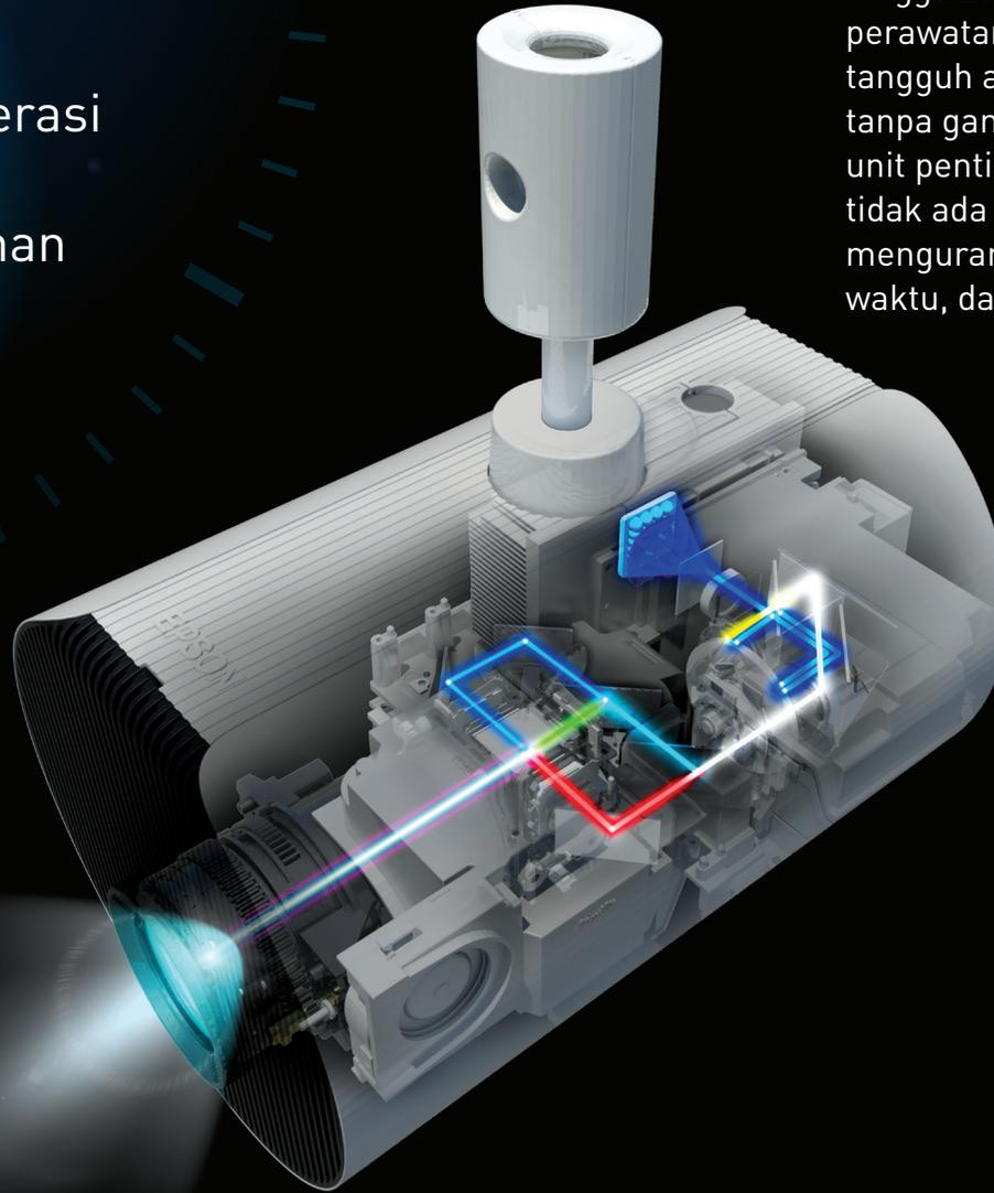
Dengan komponen utama seperti laser diode, panel 3LCD anorganik, dan phosphor wheel yang sepenuhnya tertutup rapat, Anda dapat memproyeksikan konten dengan tenang hingga 20.000 jam tanpa perlu downtime untuk perawatan. Proyektor EV-110/115 dirancang tangguh agar dapat beroperasi lebih lama tanpa gangguan, sekaligus melindungi unit-unit penting dari kontaminasi. Yang terpenting, tidak ada lampu yang perlu diganti, sehingga mengurangi biaya operasional, waktu, dan kerumitan.
