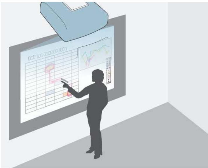
โหมด Annotation ทำให้ฉายจากคอมพิวเตอร์ อุปกรณ์ tablet, วีดีโอ หรือ ॥แหล่งอื่นๆ ॥ และเพื่อ ข้อสังเกตไปยังเนื้อหาที่ฉายโดยใช้ปากกาอินเตอร์แอคทีฟ หรือ มือ (EB-1430Wi) สามารถใช้ปากกา ทั้งสองในเวลาเดียวกัน สามารถใช้ปากกาและน้ำในเวลาเดียวกัน (EB-1430Wi)
