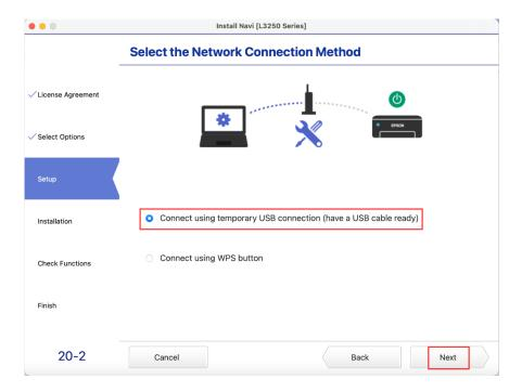
21. จะปรากฏหน้าต่างให้เชื่อมต่อสาย ให้ทำการเปิดเครื่องพิมพ์ และต่อสาย USB ระหว่างคอมพิวเตอร์ และเครื่องพิมพ์
