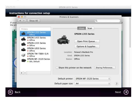
23. คลิก + จากนั้น คลิก Add Printer or Scanner เพื่อเพิ่มเครื่องพิมพ์
